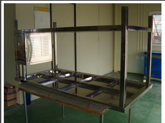
1차 Cleaning으로 용접 및 Buffing(빠우) 작업으로 생긴 얼룩 및 먼지 제거
