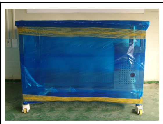
2차 Cleaning 후 투명랩으로 1차포장 후 청랩으로 2차 포장 완료
