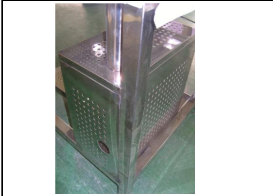
용접 및 Buffing(빠우) 작업으로 인한 얼룩 및 먼지 발생
